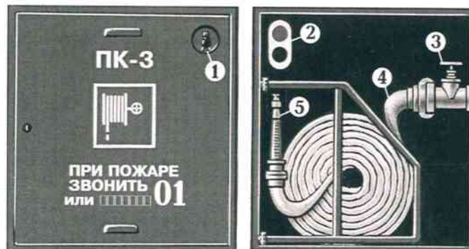
Рис. 10. Внутренний пожарный кран:
