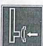
Пожарный сухотрубный стояк
