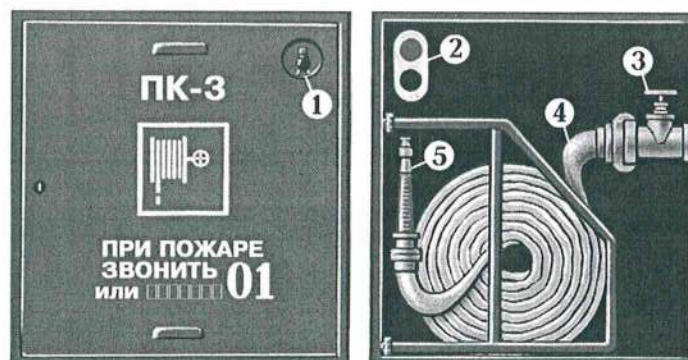
Рис. 10. Внутренний пожарный кран: 1 — место хранения ключа; 2 — пульт дистанционного включения насоса-повысителя; 3 — пожарный кран; 4 — пожарный рукав; 5 — ствол
