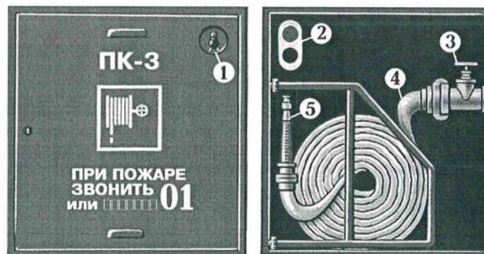
Рис. 10. Внутренний пожарный кран:
