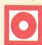
Кнопка включения установок (систем) пожарной автоматики
