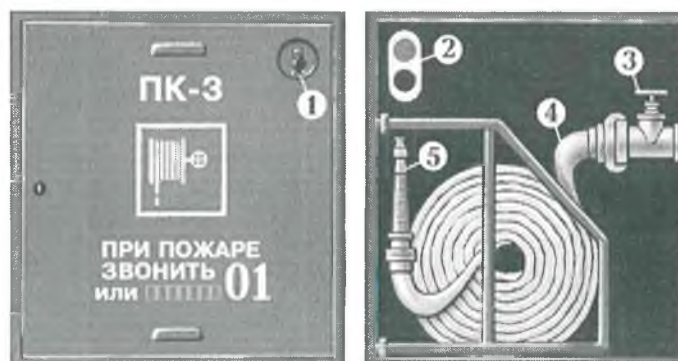
Рис. 10. Внутренний пожарный кран:
