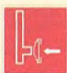
Пожарный сухотрубный стояк
