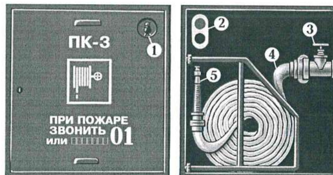
Рис. 10. Внутренний пожарный кран:
