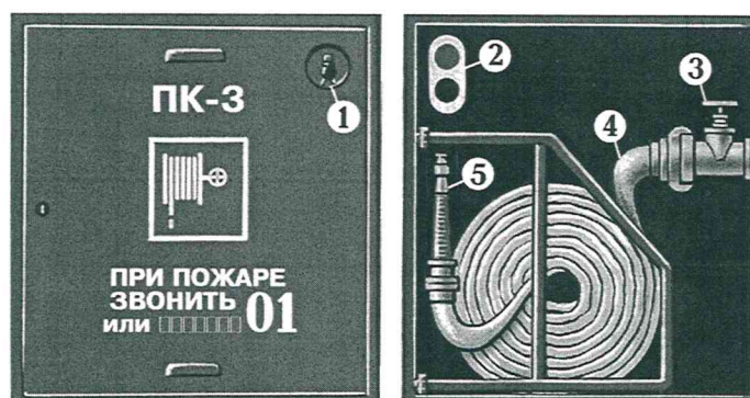
Рис. 10. Внутренний пожарный кран:
